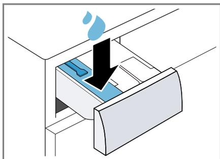
5. Inserire nello scomparto per il dosaggio manuale il detersivo universale in polvere con candeggiante.
