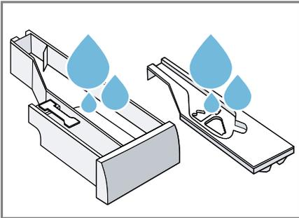
9. Asciugare e inserire il cassetto del detersivo, il coperchio e l'unità della pompa.
